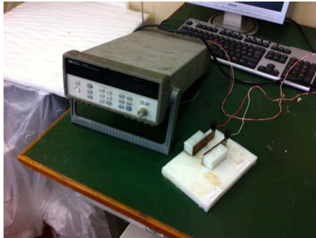
Figura 3.11: L' HP 34970A Data Acquisition/Switch Unit (a sinistra) e la struttura per la rilevazione (a destra)
