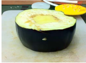
Figura 3.8: Un modellino, visto di lato. Il solido rappresentante la massa tumorale è visibile solo superficialmente, il resto del suo volume è incastrato all'interno dell'avvallamento appositamente creato per ospitarlo nella melanzana.
