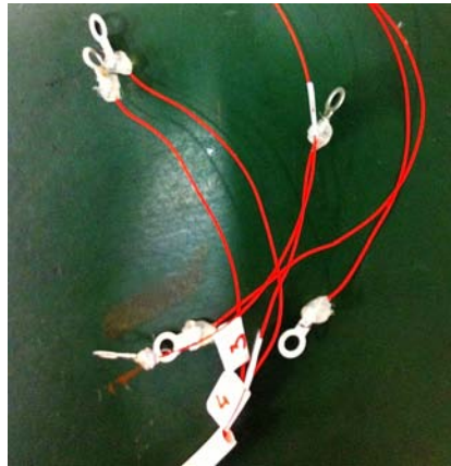
Figura 3.6: I terminali di contatto dell' elettrodo, permettono di accedere alla contattiera
