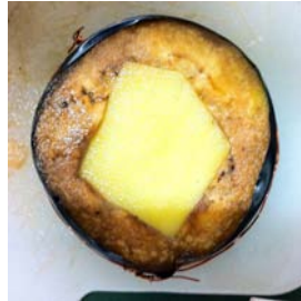
Figura 3.9: Un altro modellino, di dimensioni minori in termini di tessuto sano rispetto a quello della Figura 3.7 (visto dall'alto). E' possibile notare come a cingere i bordi della melanzana ci sia del filo metallico, stretto quanto più possibile, con funzione costringente: si cerca di minimizzare eventuali fessure fra i due tessuti.
