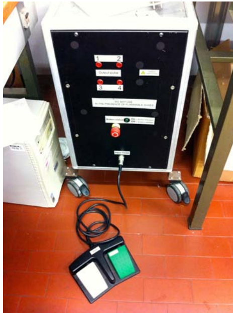
Figura 3.10: Il generatore di Impulsi per ECT
