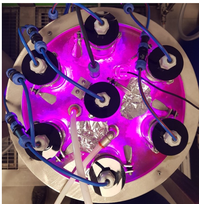
Figura 24 - Vista superiore del modulo fotobioreattore base, con le lampade LED inserite ed accese.
