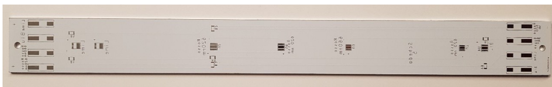
Figura 46 - Scheda PCB obsoleta utilizzata per la realizzazione della lampada LED ausiliaria.
