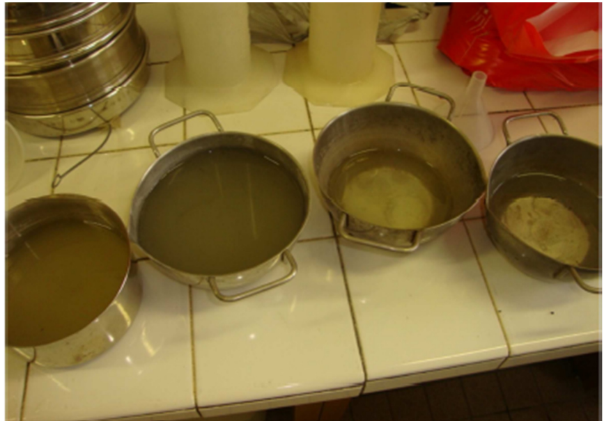
Figura 6: Acqua in uscita dal filtro prima (sinistra) e dopo (destra) il processo di backwash
