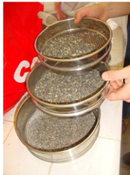
Figura 3: Setacci utilizzati in sequenza per la differenziazione della sabbia
