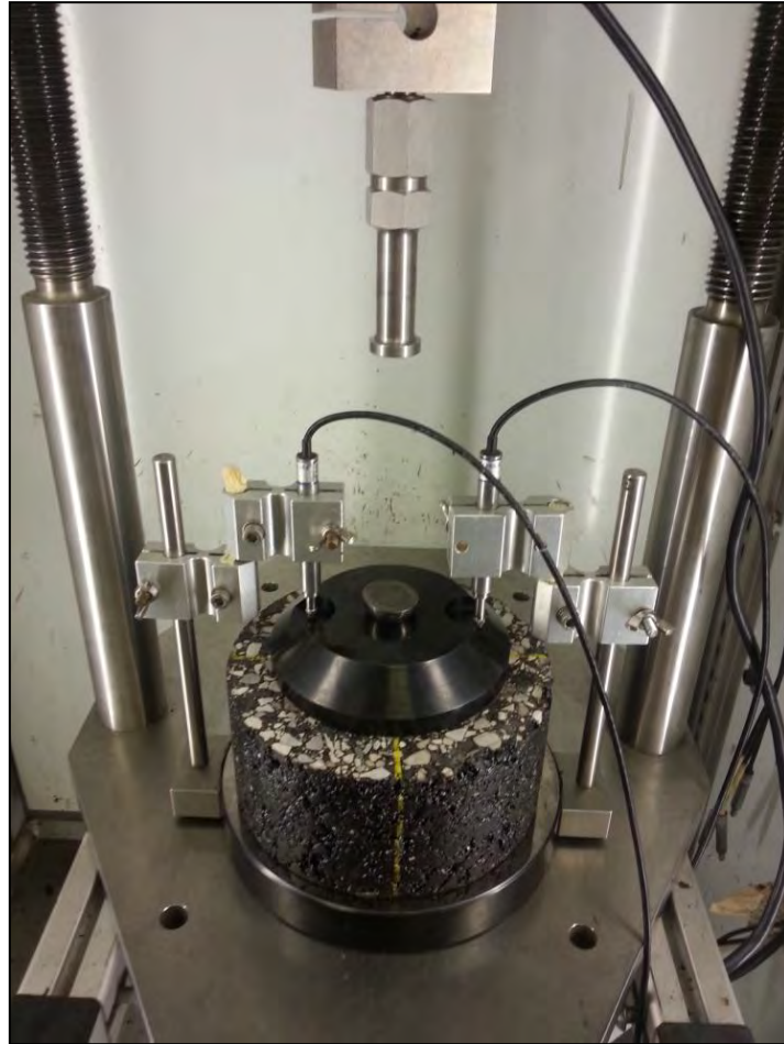
Figura 11.2. Posizionamento provino sotto alla pressa della Copper
