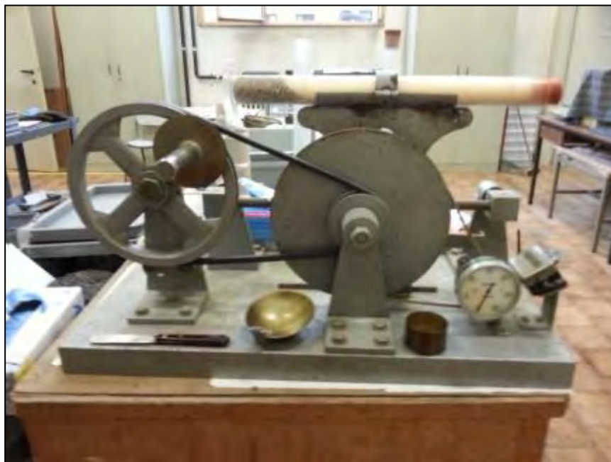
Figura 3.2. Strumento per l'agitazione delle provette
