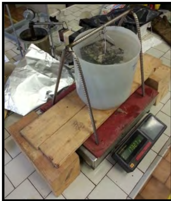
Figura 3.6. Bilancia col provino immerso nel recipiente
