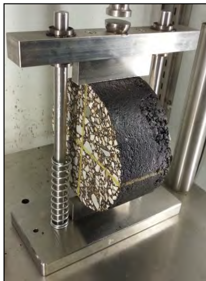
Figura 12.3. Telaio per prova ITFT
