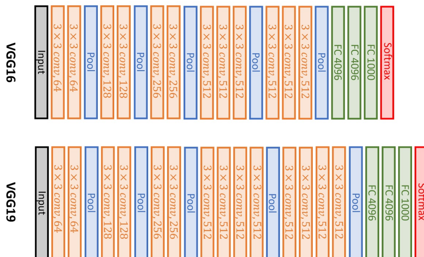
Figura 3.5: Differenza di architettura tra la VGG16 e VGG19
