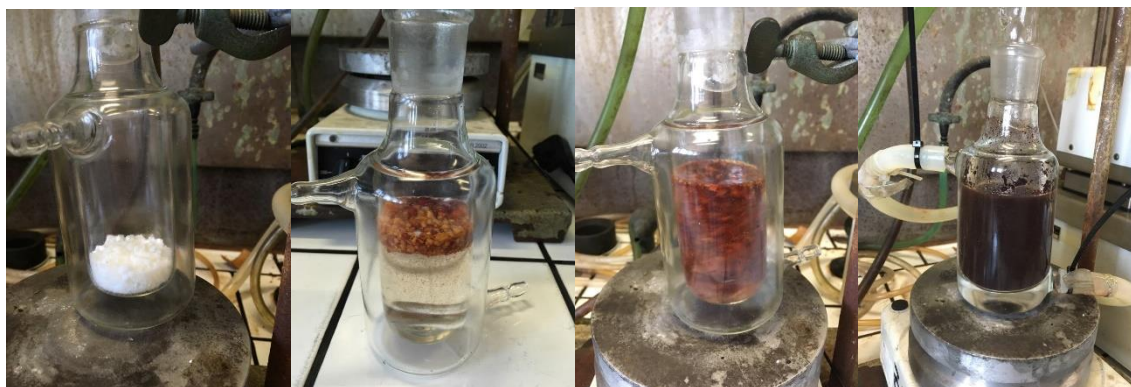
Figura 11. Cambiamento di colore del PDVB durante la solfonazione. Rispettivamente da sinistra verso destra: rigonfiamento, aggiunta dell'acido solforico, metà solfonazione e fine solfonazione.
