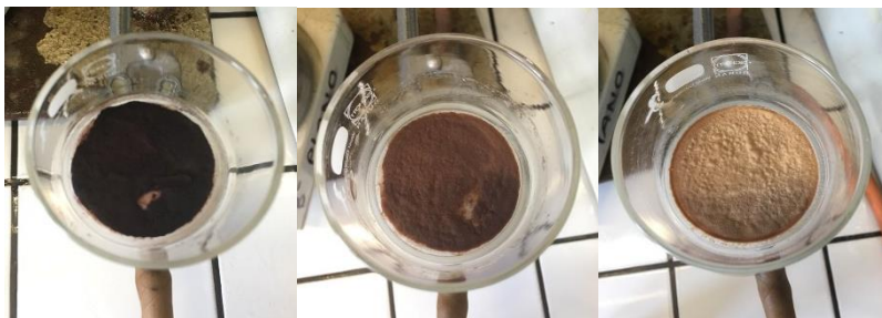
Figura 12. Cambiamento di colore della resina da inizio lavaggio (sinistra) a fine lavaggio (destra).
