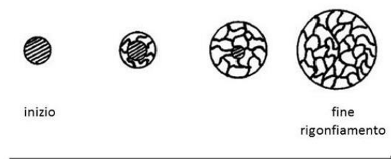
Figura 2. Processo di rigonfiamento caratteristico di una resina di tipo gel [17].
