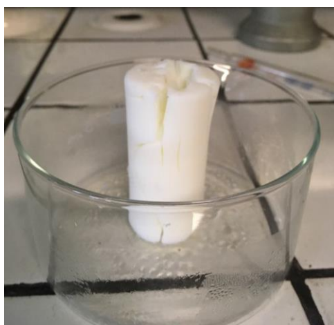
Figura 10. Monolita di PDVB ottenuto in condizioni solvotermali.
