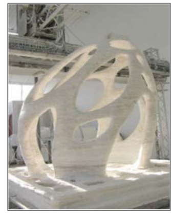
FIG. 26 – D-Shape: Divisione dell'elemento sezionato
