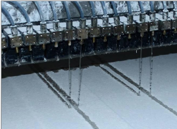
FIG. 22 – Binder Jetting: gli ugelli rilasciano il legante liquido sul letto di polvere
