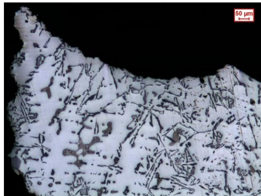
Figura 3.2: Micrografie lega A, 10 °C/min.
