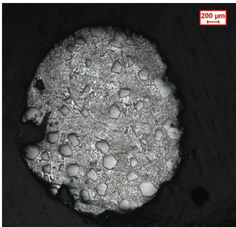
Figura 3.34: Micrografie lega H, 2 °C/min.
