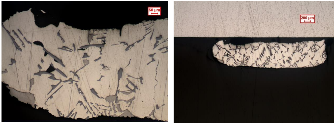
Figura 3.4: Micrografie lega A, 0,2 °C/min.
