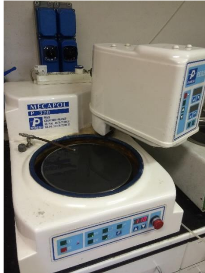
Figura 2.5: Lappatrice utilizzata in laboratorio per la sgrossatura e finitura dei provini.
