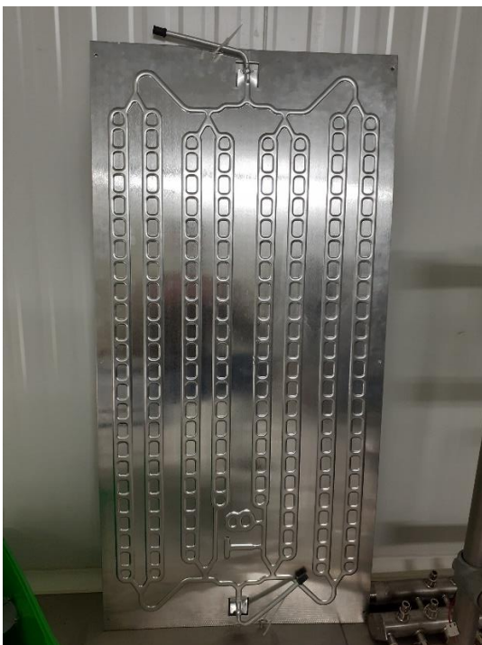
Figura 3. Configurazione del canale del roll-bond in serie.
