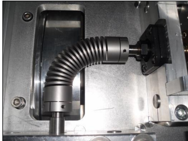
Figura 2. 24 Giunto elicoidale installato sul test bench
