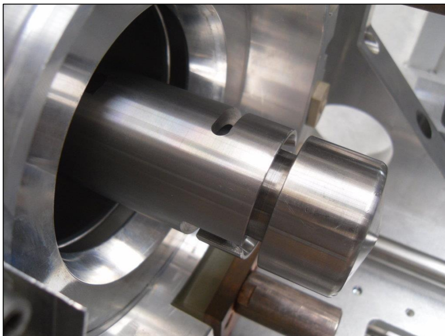
Figura 5. 10 Posizionamento incompleto del puller pulito dentro il tubo di estrazione
