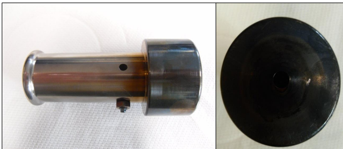
Figura 1. 24 Elettrodo di estrazione dopo anni di utilizzo e foro nel quale viene convogliato il fascio ionico
