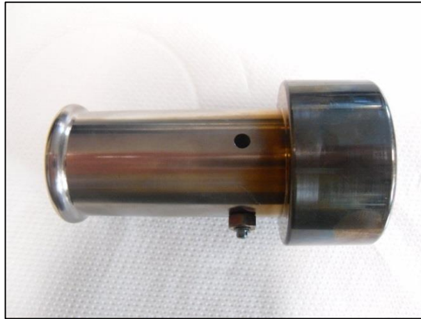
Figura 2. 13 Elettrodo di estrazione degradato dalle radiazioni
