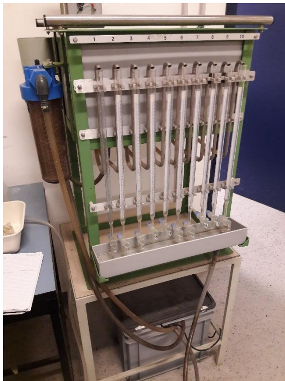
Figura 10. Permeametro da laboratorio Eijkelkamp, utilizzato nelle stime della conducibilità idraulica al saturo.
