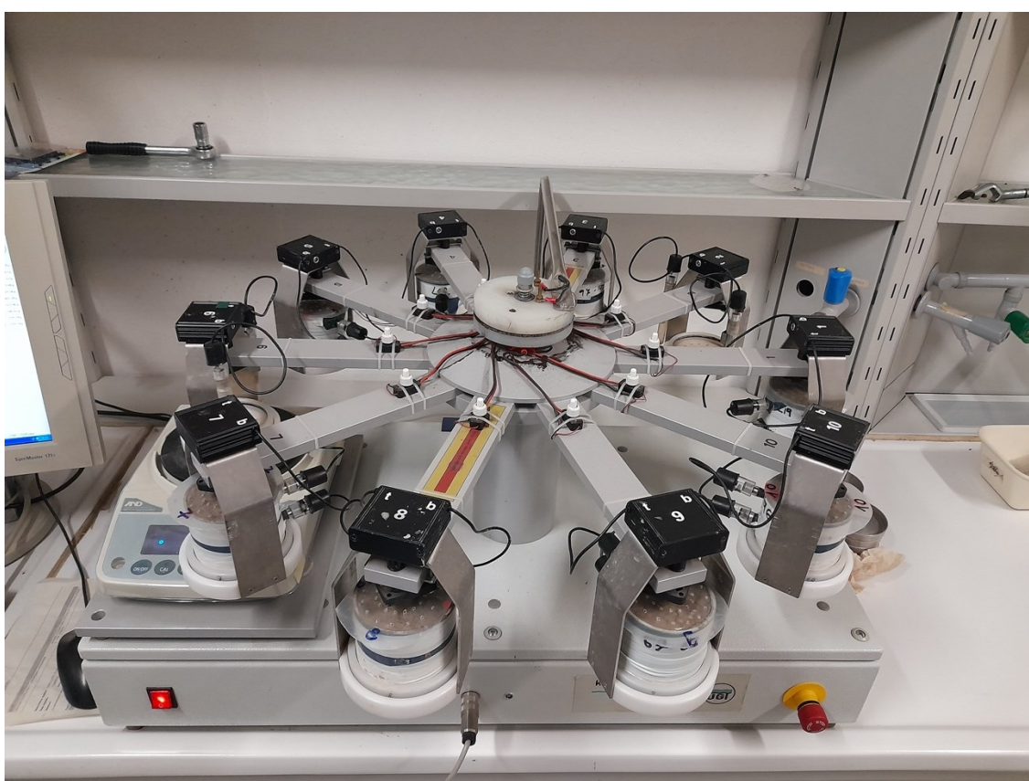
Figura 11. Ku-pF Apparatus, strumento di misura del peso dei campioni e della relativa tensione, utilizzato al fine di realizzare la curva di ritenzione idrica.
