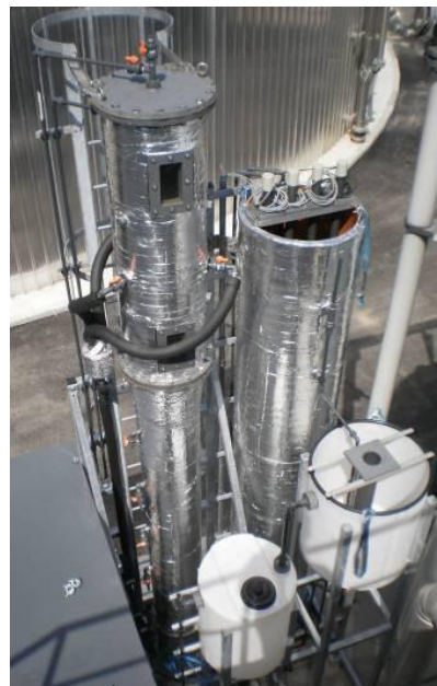
Figura 31. Visione dall'alto del reattore ANAMMOX.
