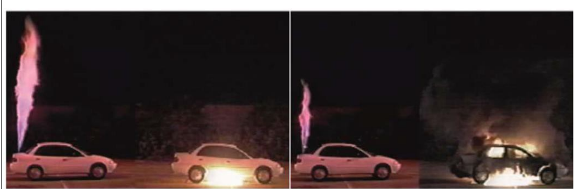
Figura 3.3.1: Jet fire d'idrogeno ed incendio di benzina a 3s (sx) e a 60s (dx) dopo l'iniziazione dell'incendio del veicolo
