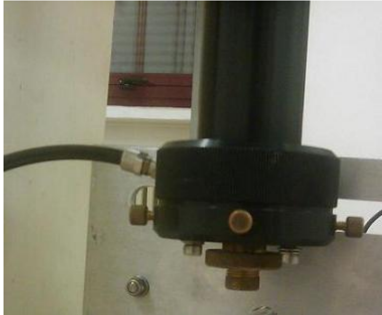
Figura 5.1: Focalizzatore con focale a 100 mm.
