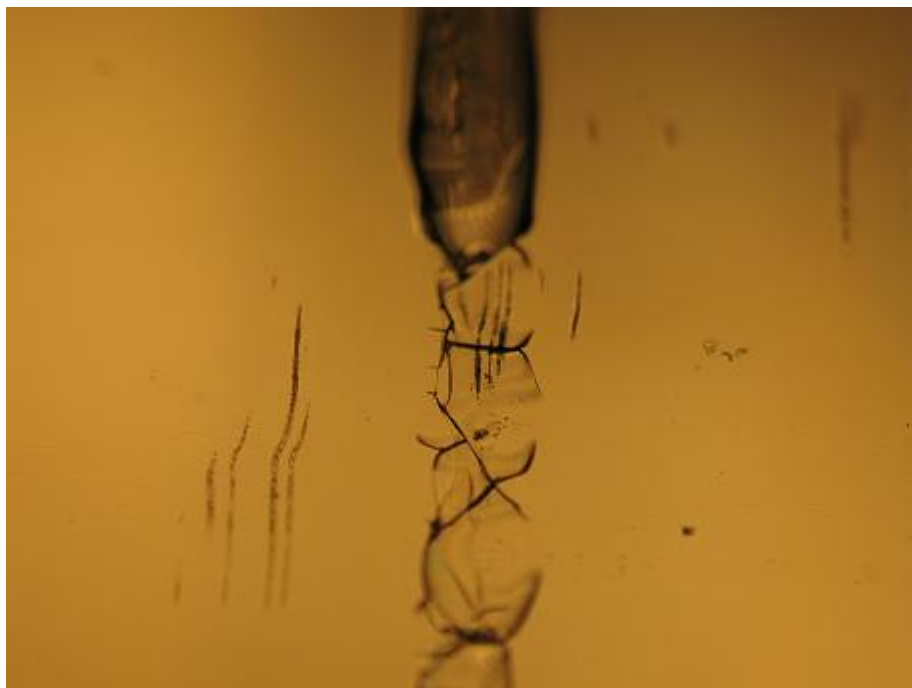
Figura 5.38: A 5 W si stacca una scaglia stacca e c'è frammentazione.
