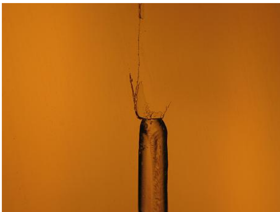
Figura 5.38: A 5 W si stacca una scaglia stacca e c'è frammentazione.
