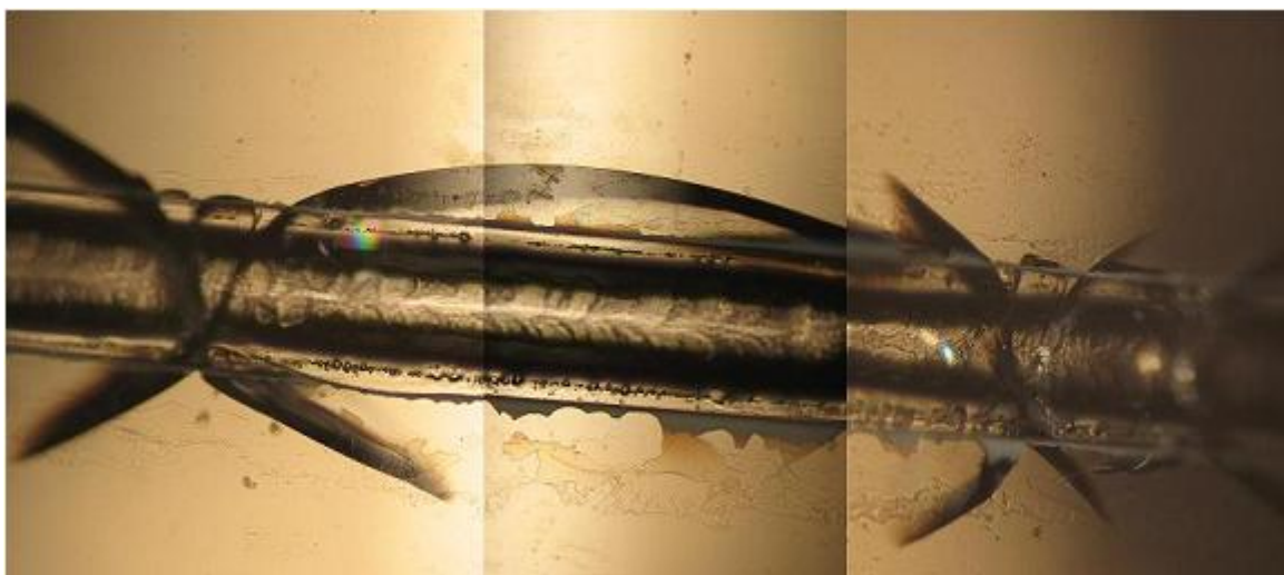
Figura 5.22: A potenze di 80 W di norma si ottengono anche fentiture a X, che si estendono anche ben oltre i bordi del solco.
