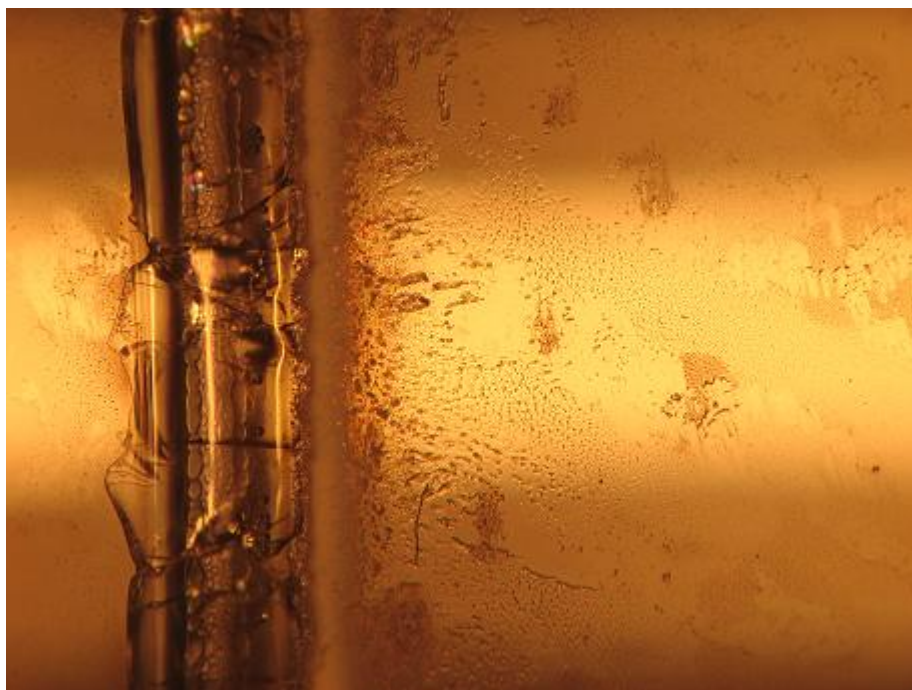
Figura 5.23: A potenze di 20 W il solco scavato è molto meno profondo rispetto al caso precedente.
