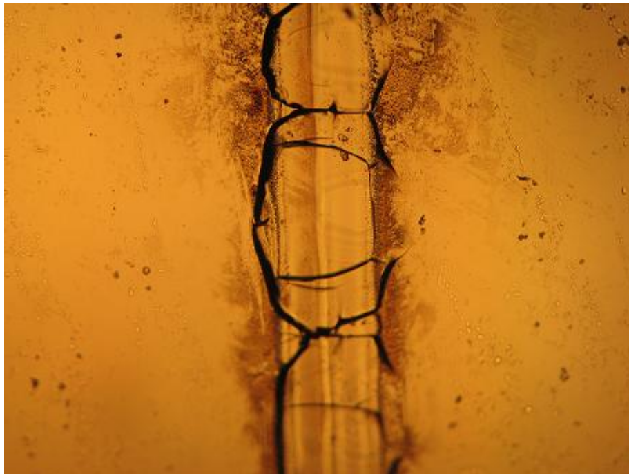
Figura 5.58: A potenze di circa 8.5–10 W si ha la formazione di crepe trasversali su tutta la circonferenza, nonostante l'alta velocità di rotazione (5 rps).
