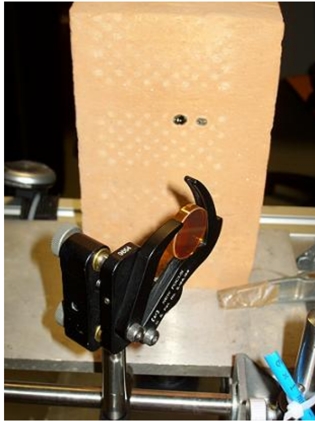
Figura 5.8: Finestra in seleniuro di zinco e mattone usato come beam dumper.
