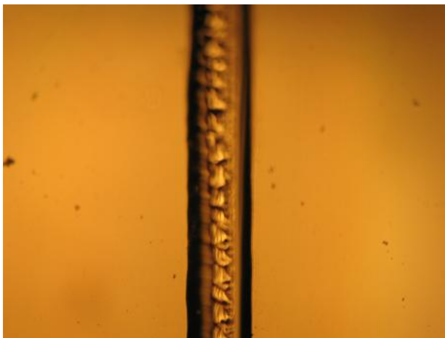
Figura 5.70: Essa dà talvolta, a distanza di tempo, il distacco di scaglie lungo l'incisione.
