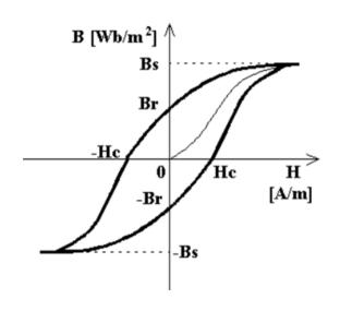
Il modello di Chan richiede di conoscere i parametri geometrici (lunghezza, sezione, numero spire e gap) e magnetici del nucleo, quali campo coercitivo  $H_{\rm c}$ , campo residuo  $B_{\rm r}$  e campo di saturazione limite  $B_{\rm s}$ .
