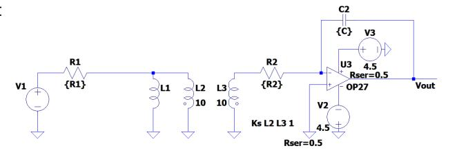
È stato implementato un integratore attivo utilizzando un **amplificatore** operazionale (OP27) con lo scopo di analizzare anche basse frequenze.
