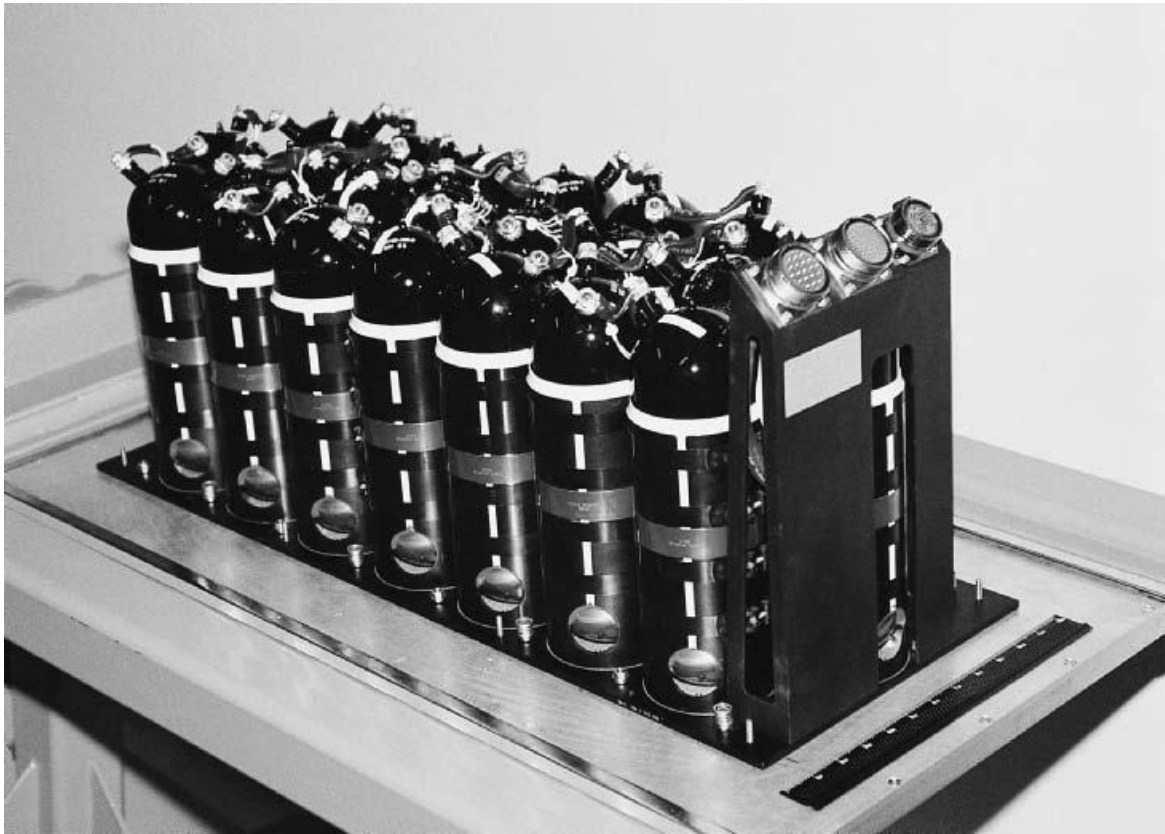
Figura 93 Assemblaggio di batterie al nichel-idrogeno DMPS, 100-Ah.
