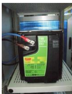
Figura 131 Batteria ZEBRA 48TL80-NV in test presso CNR-ITAE.
