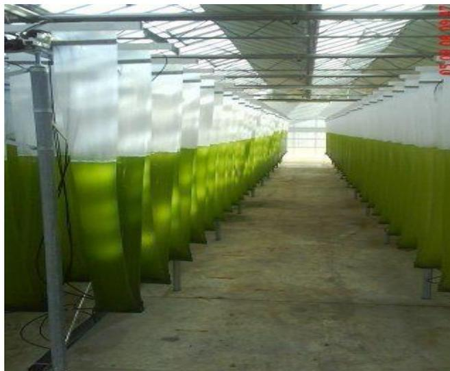
Figura 1.3 fotobioreattori tubolari verticali di tipo air lift.
