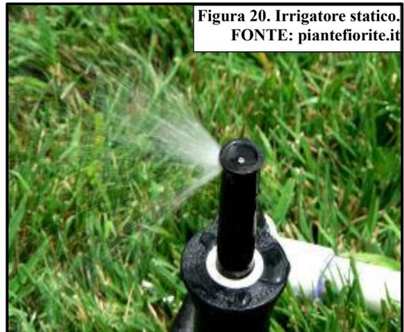
Figura 20. Irrigatore statico.
