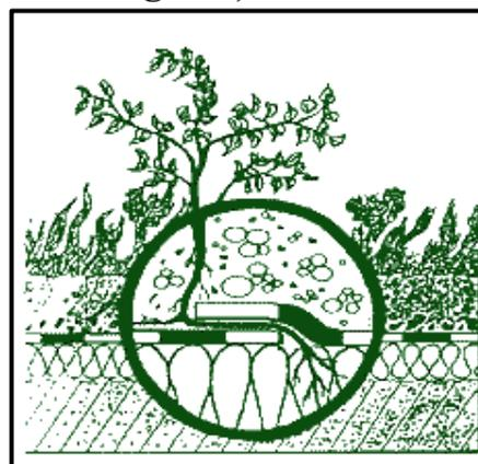
Figura 10. Esempio di danni causati da una posa non corretta dell'impermeabilizzazione, priva di
