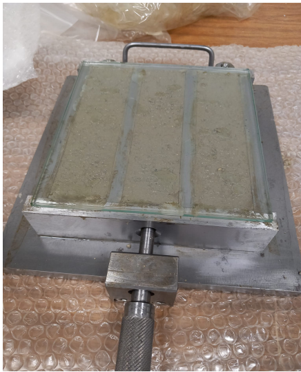
Figura 4.8: A sinistra, i casseri in acciaio utilizzati per le malte. A destra, le misure dei casseri secondo standard
