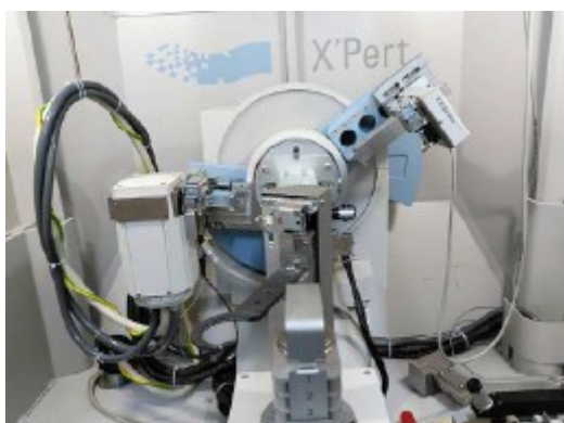
Figura 3.10: Diffrattometro PANalytical X'Pert PRO, rivelatore X'Celerator
