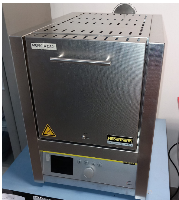
Figura 3.14: Forno elettrico a muffola utilizzato per la calcinazione e i i trattamenti ad alta temperatura
