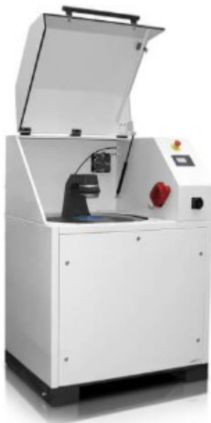
Figura 4.1: Modello di macinatore simile a quello utilizzato. Il disco di agata viene adagiato nell'apposito vano visibile nell'immagine, e fissato tramite una leva.
