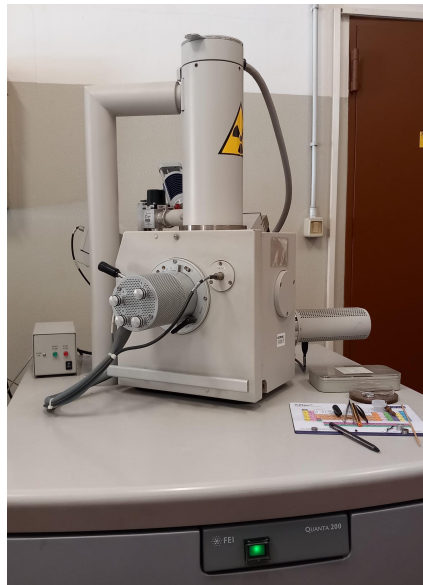
Figura 3.15: Microscopio elettronico a scansione (SEM) FEI Quanta 200, utilizzato per l'analisi in questo studio
