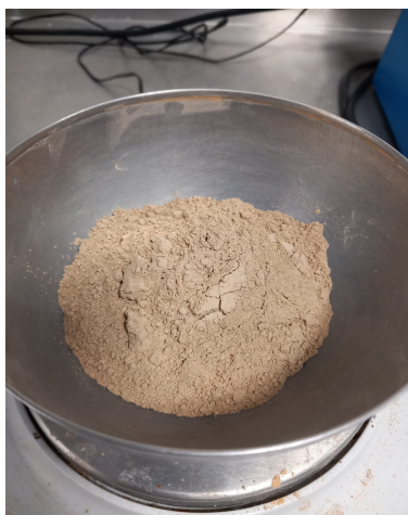
Figura 3.6: Kunkur fines, il tipo di caliche utilizzata in questo studio
