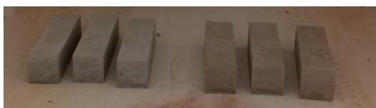
Figura 4.4: Campioni di miscela estratti dai casseri dopo 28 giorni
