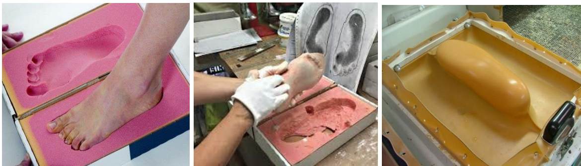
Figura 29: fasi del processo di realizzazione di plantare su calco [45,46,47]
