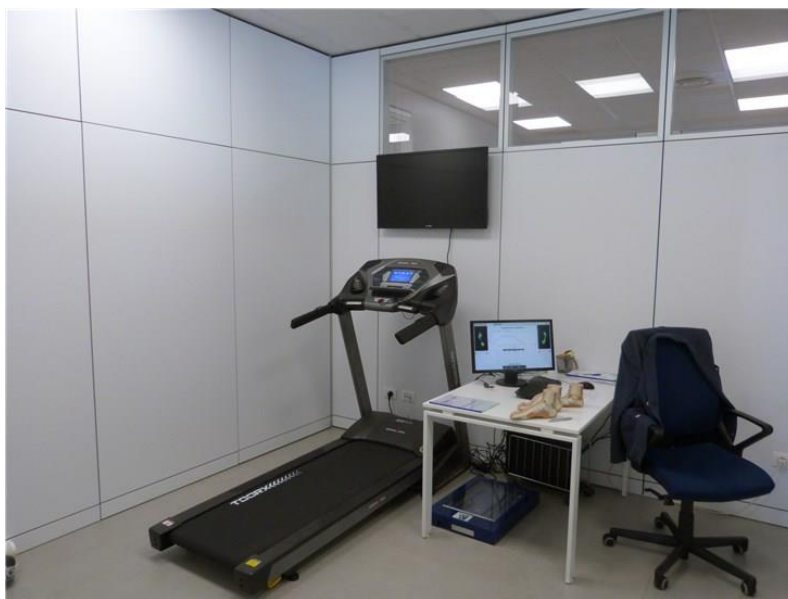
Figura 32: Treadmill baropodometrico di Impronta Medica [57]
