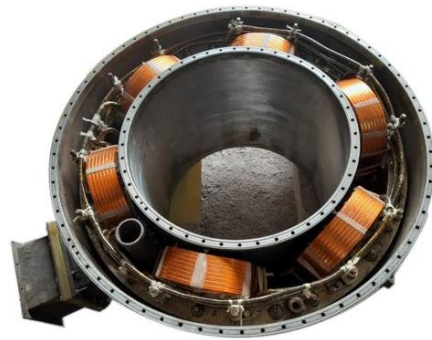
Fig 1.8: Schema di mescolamento rotativo della fase liquida nel lingotto Fig 1.9: Comune stirrer rotativo da colata continua
