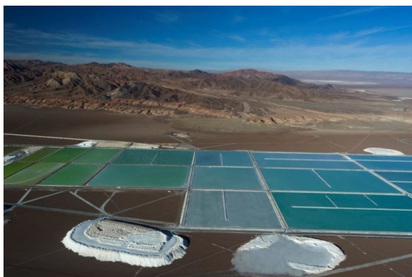
Figura 7 – L'estrazione del litio avviene attraverso l'evaporazione di enormi stagni artificiali
