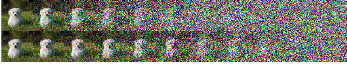
Figura 2.3: Progressione del rumore usando una varianza lineare (sopra) e una varianza coseno (sotto) [Nichol and Dhariwal, 2021]
