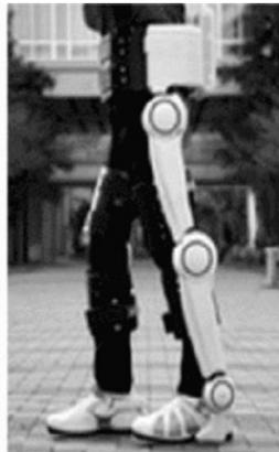
Nel frattempo, in Giappone nel 2001 l'Università di Tsukuba in collaborazione con l'azienda Cyberdyne ha sviluppato il robot HAL (Hybrid Assistive Leg) (FIG.16). Questo esoscheletro è stato progettato per dare sostegno agli arti inferiori negli utilizzatori
