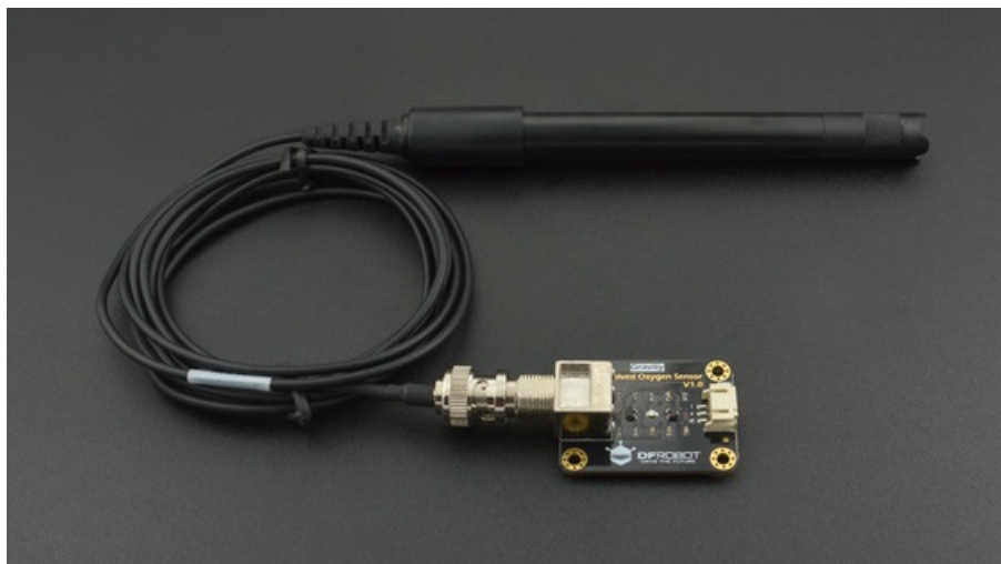
Figura 2.6: Sensore di Ossigeno Disciolto utilizzato per il prototipo [8].
