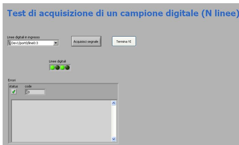
Fig. 2.10: Pannello frontale del VI, mentre vengono monitorate quattro linee digitali
