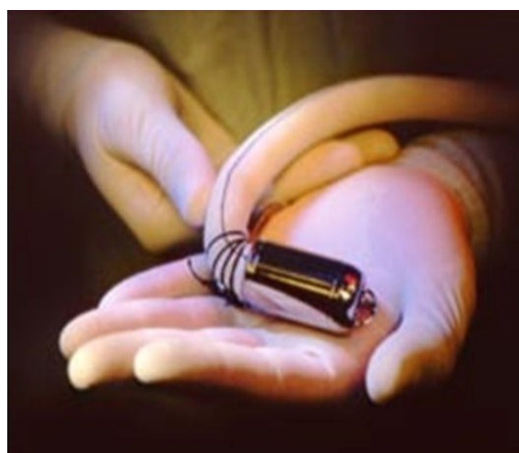
Figura 15: Pompa dello Jarvik 2000
