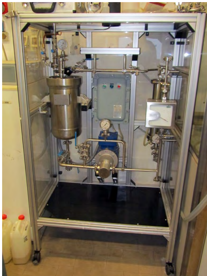
Figura 3.1 Impianto pilota multi-purpose a membrane fornito da Me.Te.
