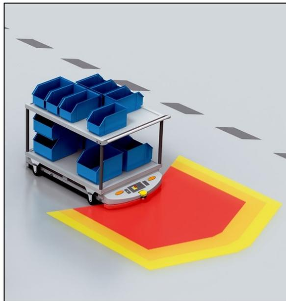
Figura 6.8 Esempio di possibile soluzione, con PLS che coprono anche una parte di superficie laterale (Fonte: Sick, 2022)
