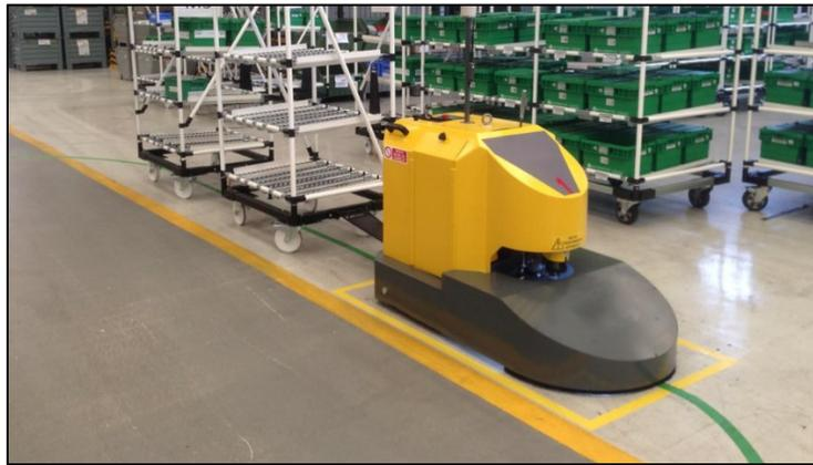
Figura 2.3 Esempio di AGV a guida ottica (Fonte: Formall, 2022)
