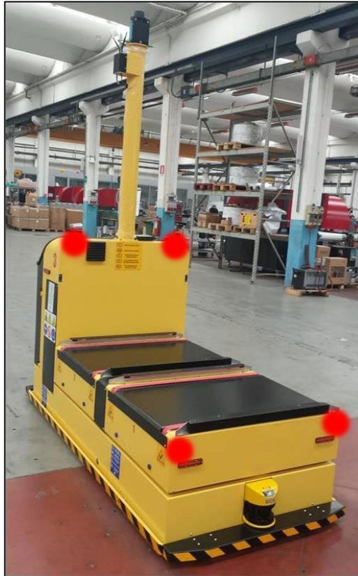
Figura 6.2 Pulsanti di arresto di emergenza del veicolo LGV (Fonte: Formall, 2022)
