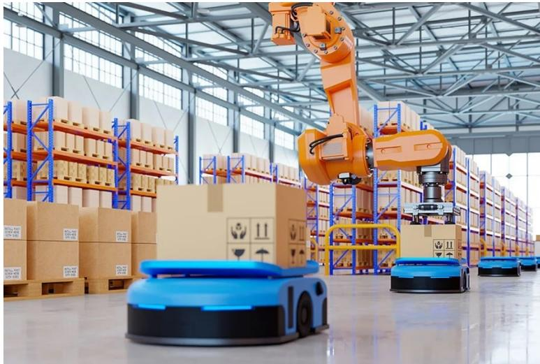
Figura 3.7 Veicoli AGV atti alla movimentazione del carico (Fonte: Deagor, 2019)
