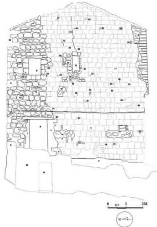
**Fig. 2.** Restituzione grafica dell'analisi stratigrafica del prospetto W in scala 1:50.
