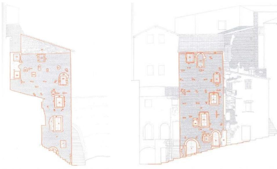
**Fig. 1 e 2. Rilievo del prospetto N e W con lettura stratigrafica (scala 1:50).**
