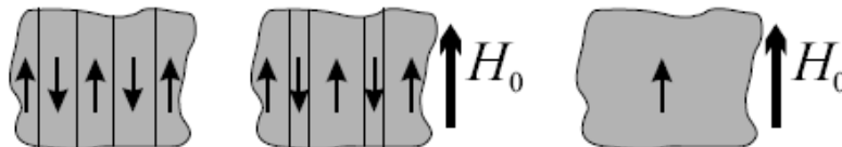
Figure II.9 : Exemple d'aimantation dans un système uniaxe sous champ parallèle
