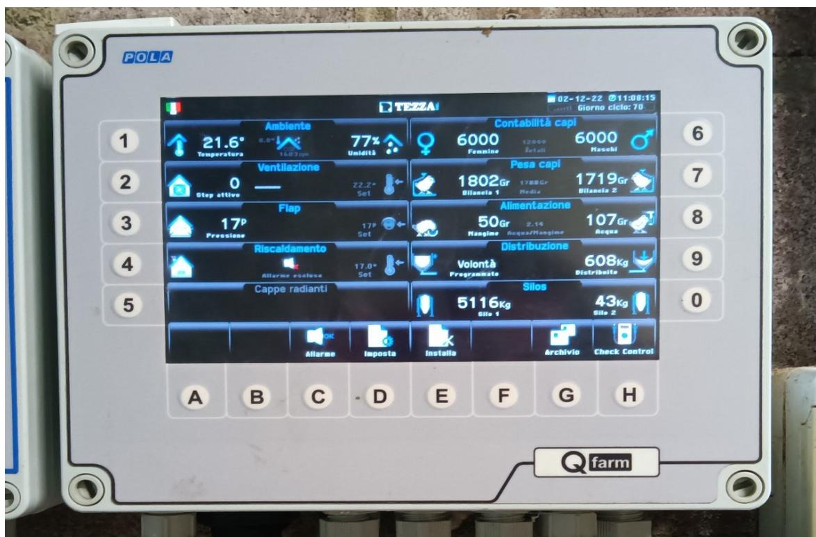
Fig. 29. Interfaccia dello schermo della centralina Q-farm. (Ditta POLA).
