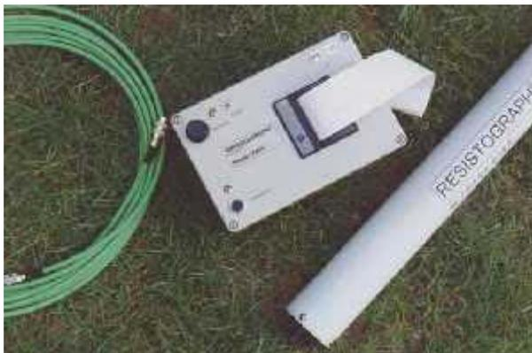
Foto 13. Resistografo con annessa stampante
