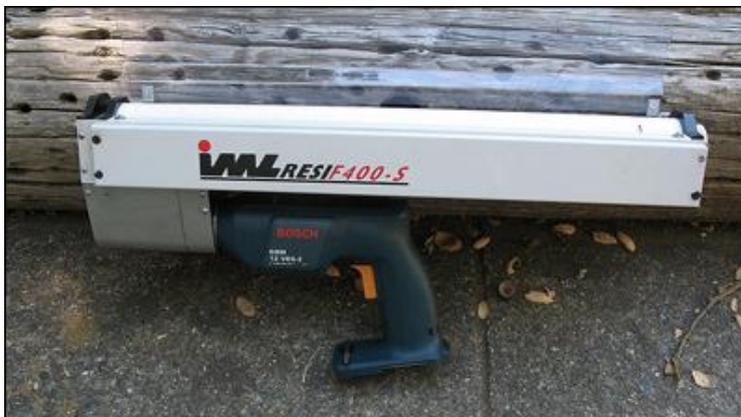
Foto 14. Resistografo di ultima generazione con perforatore ausiliario
