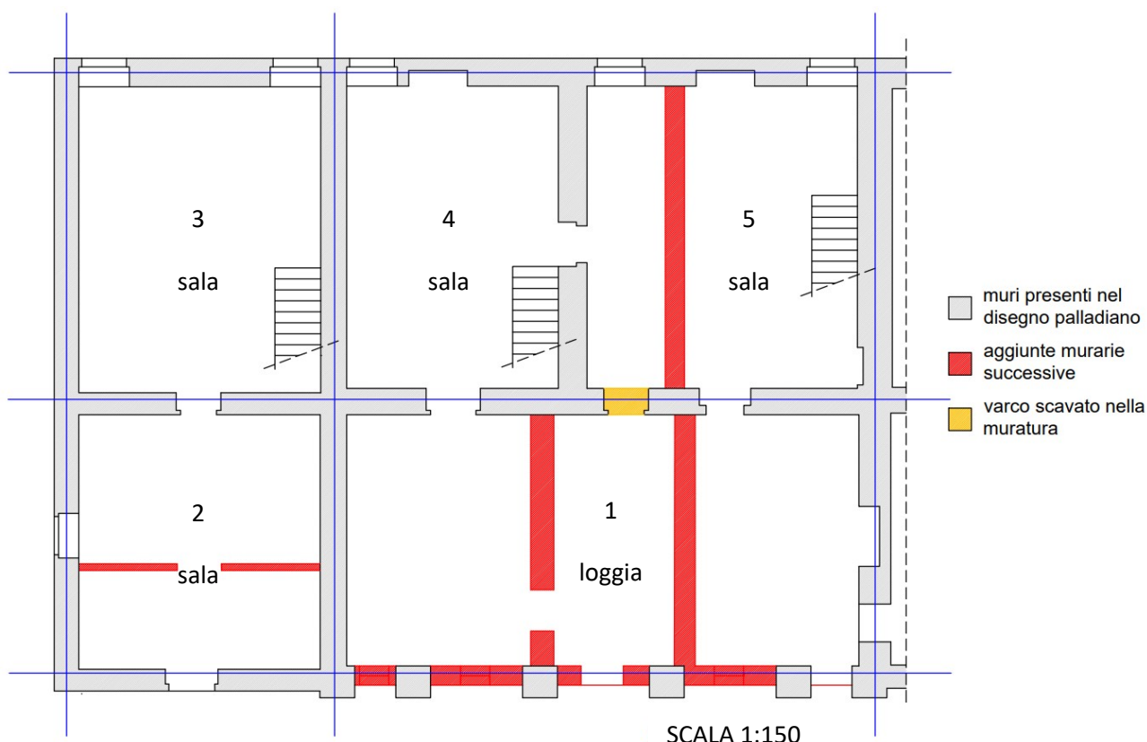
Fig.4.3 Planimetria di Villa Arnaldi (piano terra). In grigio sono evidenziati i muri presenti nel disegno palladiano, in rosso le aggiunte successive, in giallo la muratura demolita per realizzare un portale ed in blu gli assi di riferimento. (realizzato con Autocad)
