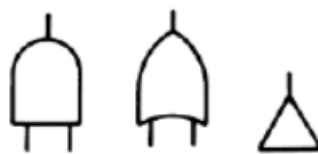
FIGURA 15 CONNETTORI LOGICI UTILIZZATI NELLA FTA
