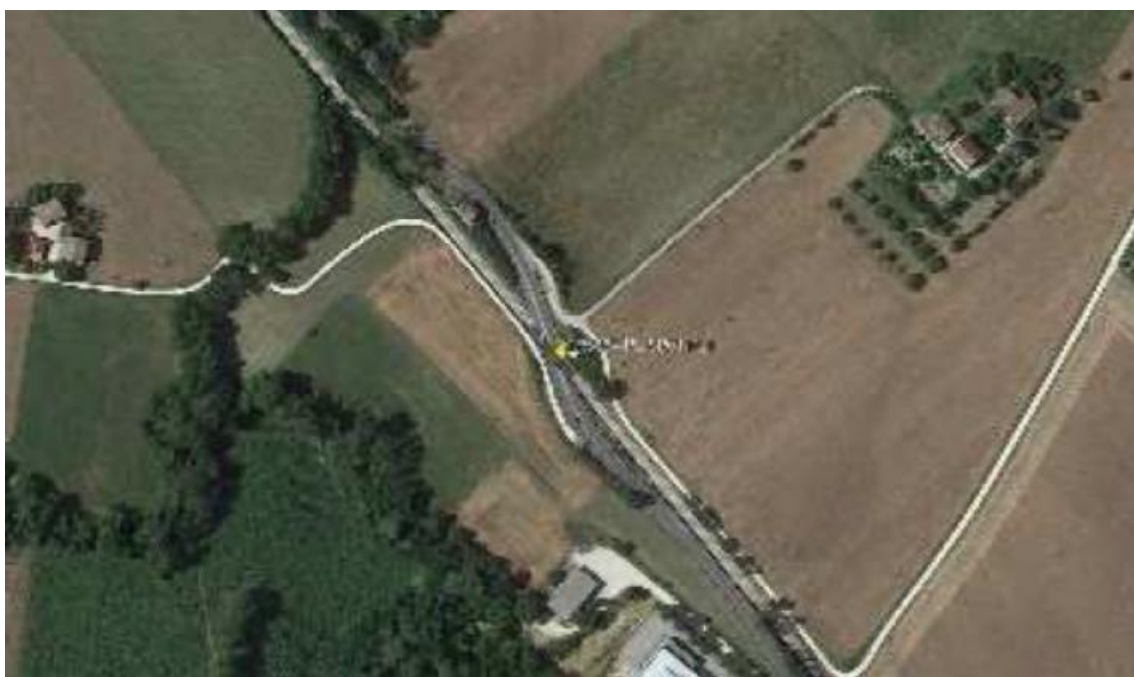
FIGURA 4 PARTICOLARE DI PL CON STRADE PARALLELE INTERSECANTI SULL'ATTRAVERSAMENTO
