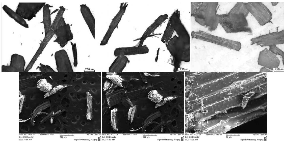
Figura 6: farina di legno osservata al microscopio ottico (in alto, scala 250 \mu\text{m} ) e al microscopio elettronico (in basso, scala 500 \mu\text{m} e 50 \mu\text{m} )
