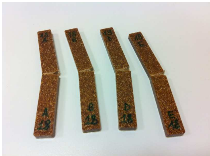
Figura 3.4.2: Campioni del composito 18 dopo l'impatto Izod, la rottura è parziale
