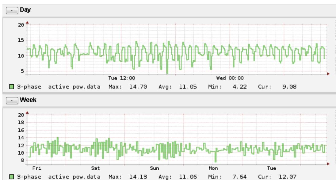
**Figura 21** - *Andamento potenza assorbita dall'impianto di condizionamento*
