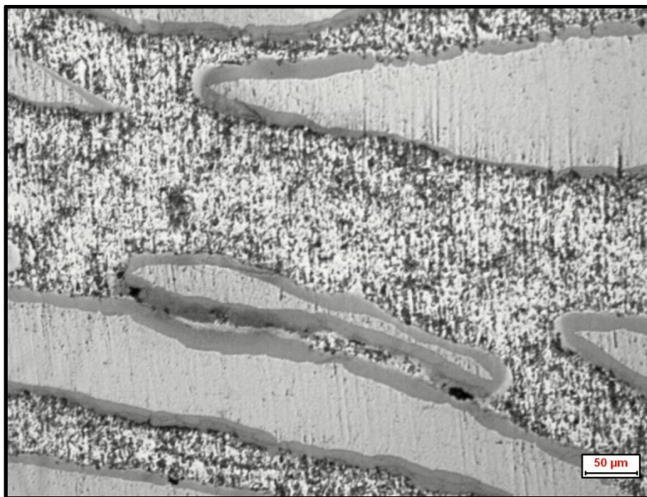
Figura 26: Immagine a 200X del campione trattato a 550°C per 4 ore
