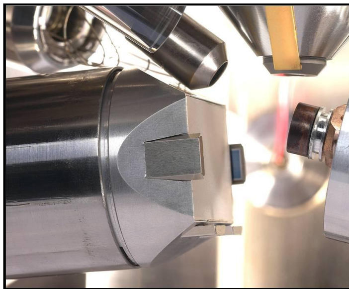
Figura 9: configurazione SEM per analisi EBSD
