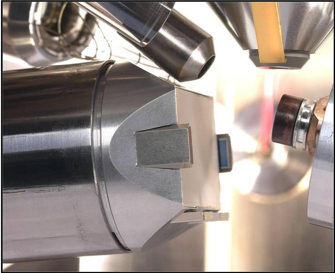
Figura 49: Configurazione interna del SEM per analisi EBSD
