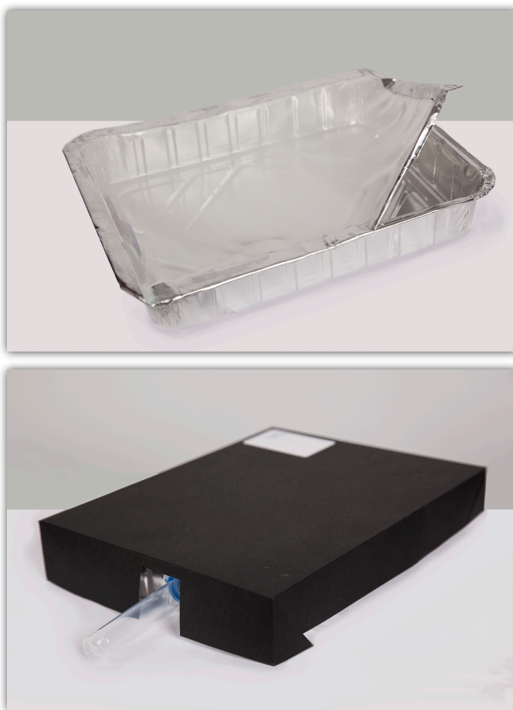
Figure 39, 40. Rispettivamente, sfarfallatoio senza copertura oscurante e provetta e sfarfallatoio completo, come appare durante il periodo di permanenza della frutta al suo interno.
