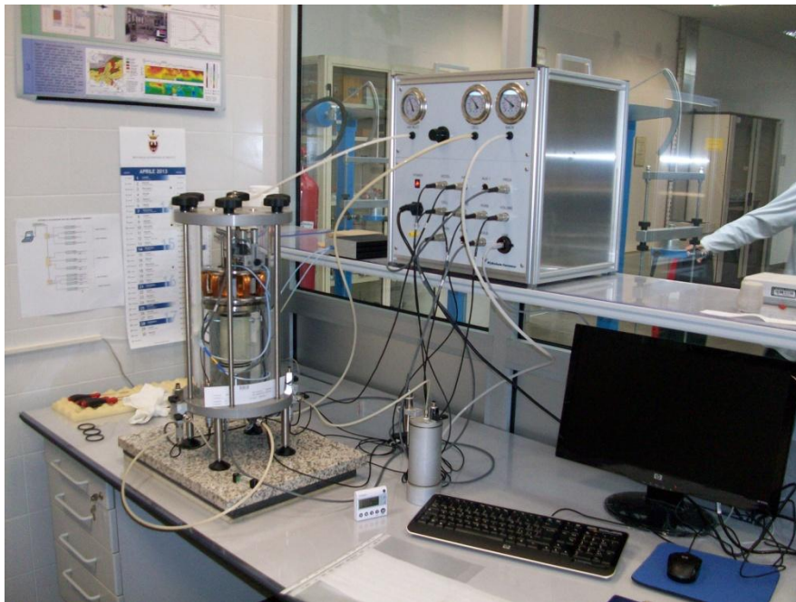
Fig. 11.3- Attrezzatura e strumentazione di colonna risonante utilizzata dal laboratorio di Geotecnica della Provincia autonoma di Trento per le analisi
