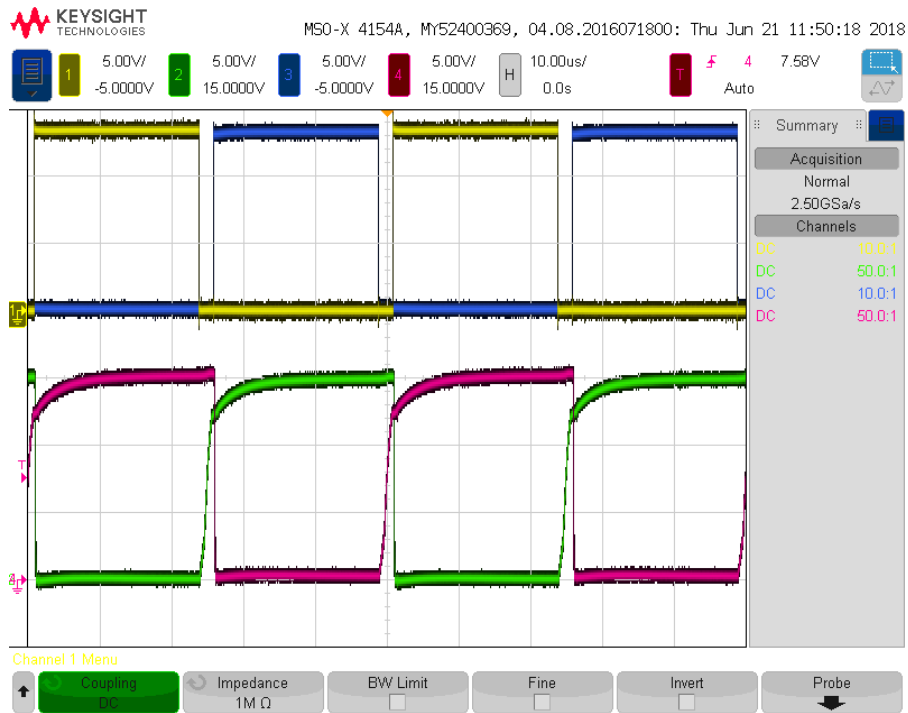
Figura 6.4: Segnali di comando in uscita dalla scheda GPIC (canali 1 e 3) ed effettivi segnali d'ingresso ai driver a valle del circuito di interfaccia (canali 2 e 3).
