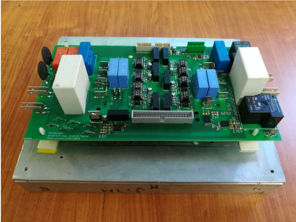
Figura 4.34: Lato superiore della scheda montata sul dissipatore priva di induttori e condensatori del dc-link.
