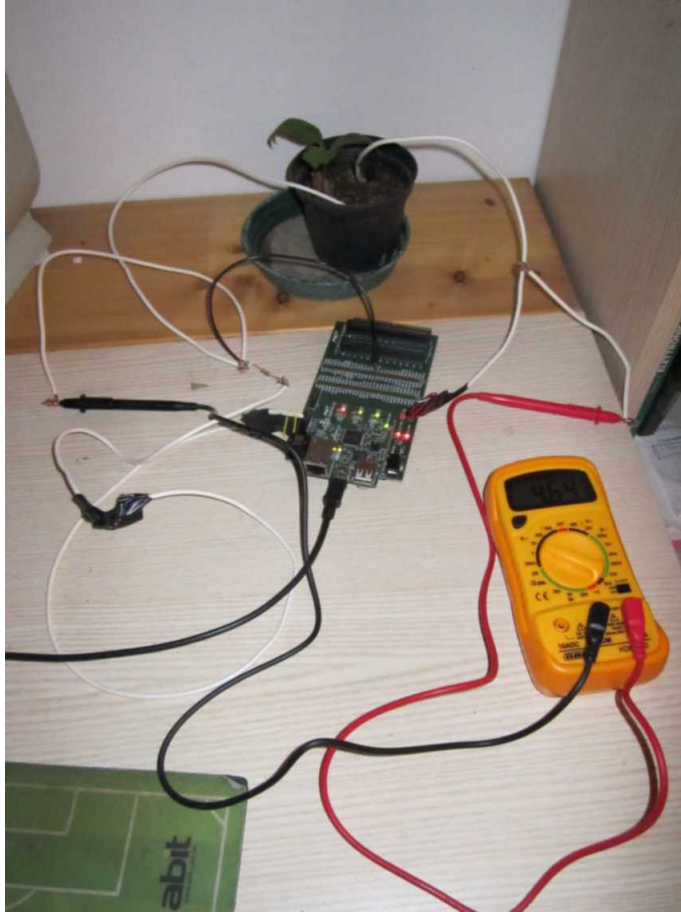
Figure 15: Postazione per la misura della tensione: il multimetro legge V_s , il microcontrollore legge V_{R_1} ;
