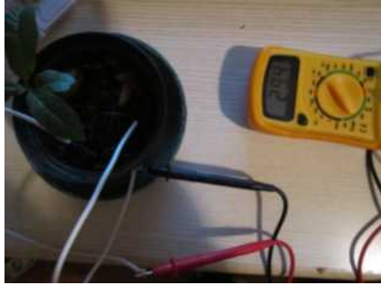
Figure 11: Prima lettura valore resistenza del terreno
