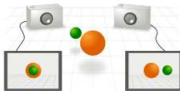
Figura 2.4: principio di funzionamento della stereovisione.
