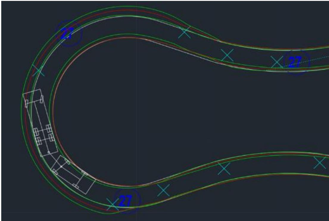
**Figura 29: autocarro 6x4 con carrello 2 assi in movimento su un tornante di 12 metri di raggio di curvatura**
