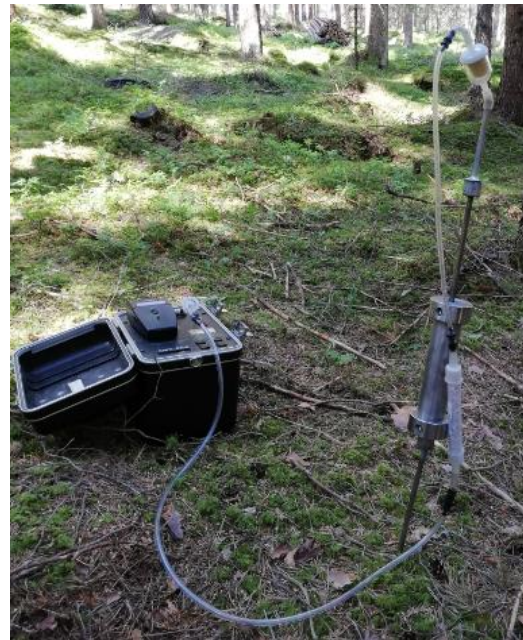
Fig. 4.12. RAD 7 DurrIDGE collegato alla sonda con un tubo in polietilene durante una misurazione dell'emissione di gas radon e thoron su suolo.
