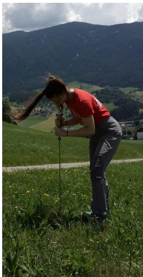
Fig. 4.7. Operatore durante la fase di inserimento della sonda nel suolo. L'ambiente circostante è ottimale al posizionamento della sonda in quanto sono poco presenti i fattori di disturbo (radici, scarpate, acqua ecc.).
