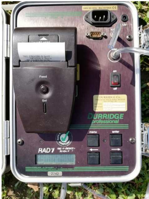
Fig. 4.11. RAD 7 DurrIDGE, display. Rilevatore di gas radon e thoron su suoli.
