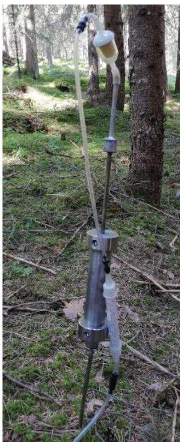
Fig. 4.6. sonda cava in metallo inserita nel terreno a 80 cm, collegata con tubo in polietilene allo strumento, è munita di filtro per il pulviscolo atmosferico e del tubo contenente drierite (essiccante).
