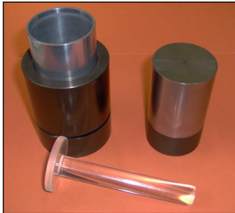
Fig. 4.3. Materiale per la preparazione delle compresse costituito da un sistema di cilindri e pistoni in acciaio.
