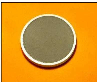
Fig. 4.4. Compressa in cui è stato inglobato il campione con supporto di acido borico.
