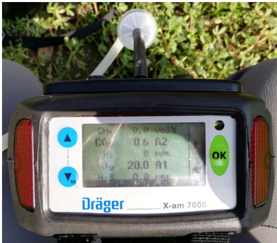
Fig. 4.8. Draeger X-am 7000, display. Rilevatore multi-gas, rileva fino a cinque gas simultaneamente.
