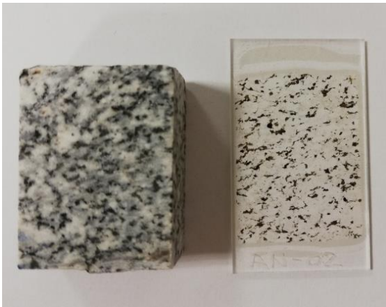
Fig. 4.2. Sezione sottile e rispettivo chip di roccia ottenuto dal retrotaglio.
