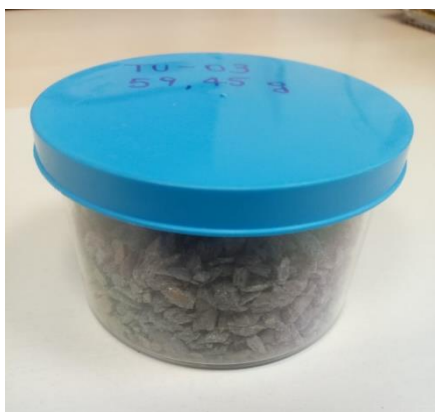
Fig. 4.1. Campione pronto per la spettrometria- \gamma . Sul coperchio viene riportato nome del campione e tara in grammi.
