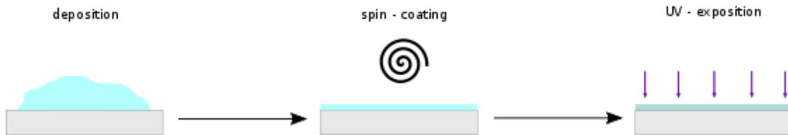
Figura 3.4: schema della preparazione delle superfici di NOA
