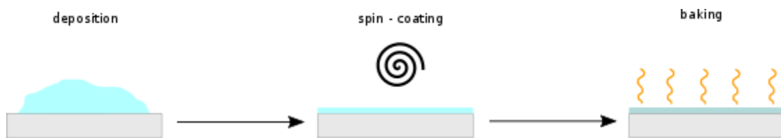
Figura 3.3: schema della preparazione delle superfici di PDMS
