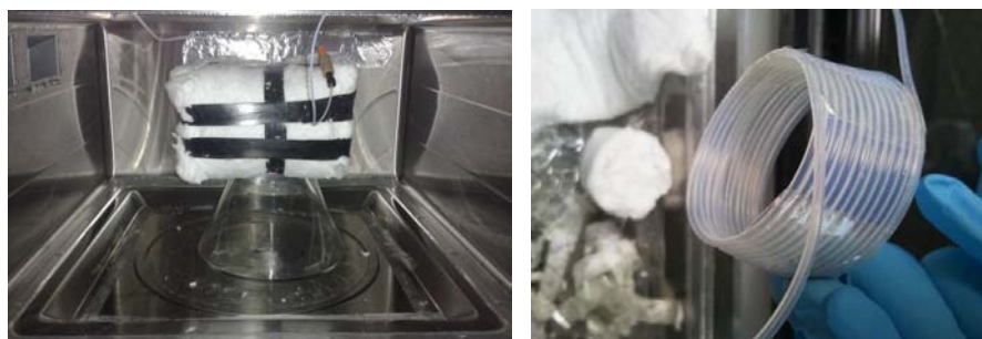
Figura 2.13: A sinistra: reattore in Teflon coibentato con lana di quarzo. A destra: sostituzione del reattore in Teflon con tubicini in Teflon disposti a formare una bobina
