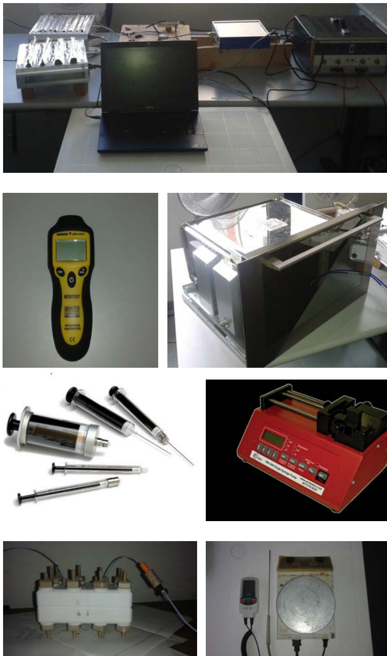
Figura 2.2: Strumentazione a disposizione nel laboratorio di via Trasea. Da in alto a sinistra: tavolo di lavoro, cavità del forno a microonde, rilevatore di campi elettromagnetici, pompa a siringa, reattore in Teflon e termocoppia
