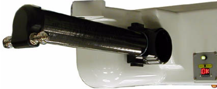
Fig. 2.2: Accoppiamento attuatore - biella
