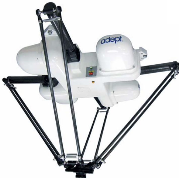
Fig. 2.1: Manipolatore Adept Quattro s650H TM
