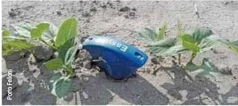
Fig.19. Sonda, di rilevamento dell'umidità. (Fonte: Porto Felloni)
