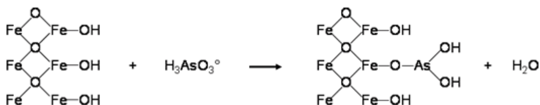
Figura [3.8] "Formazione del legame monodentato" (Bangladesh Consortium For Arsenic Management)
